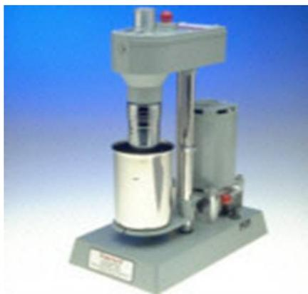
**Figura 2:** Viscosímetro Rotacional Fann 35A
