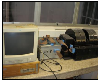
Figura 5. Aparato do teste do Rotarod (fonte: LEXDON).
