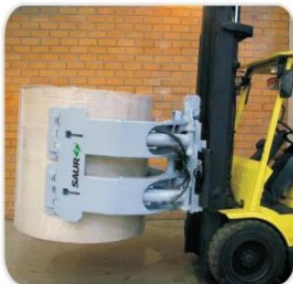
Figura 22 – Garra Giratória para Bobinas. (Fonte: Saur, 2011).
