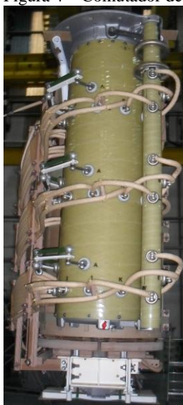
Figura 4 – Comutador de derivação em carga.
