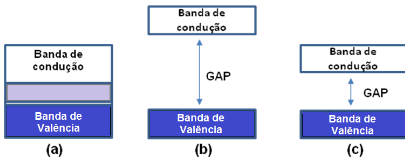
Figura 18: Relação entre as bandas de valência e as bandas de condução para: (a) materiais condutores, (b) materiais isolantes e (c) materiais semicondutores.
