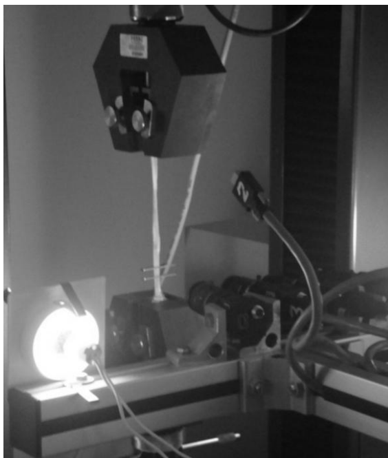
Figura Apêndice 4 Ensaio com fixação de garra de cunha e marcadores perto da garra inferior
