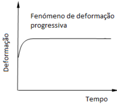
Figura 2-8 Fenômeno de deformação progressiva com carga constante, adaptada de (NORDIN; FRANKEL, 2004).
