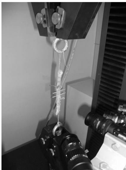
Figura Apêndice 2 Ensaio com fixação por médio de argolas, de amostra CP5
