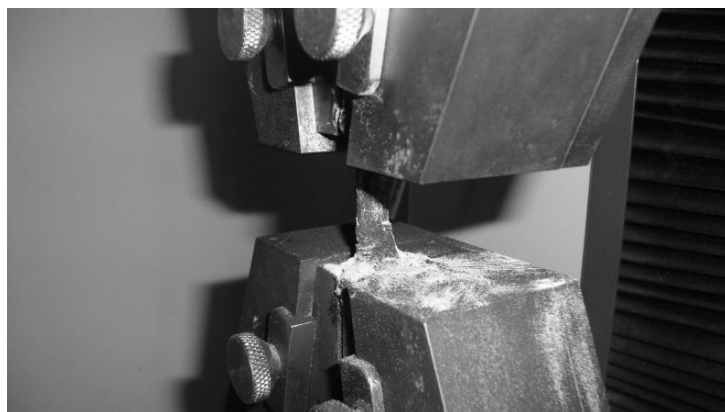
Figura Apêndice 5 Ensaio com toner e poliamida como marcador para DIC
