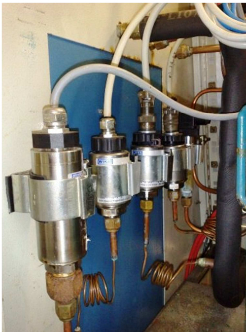
Figura 9: Transmissores de pressão utilizados na bancada protótipo [5]
