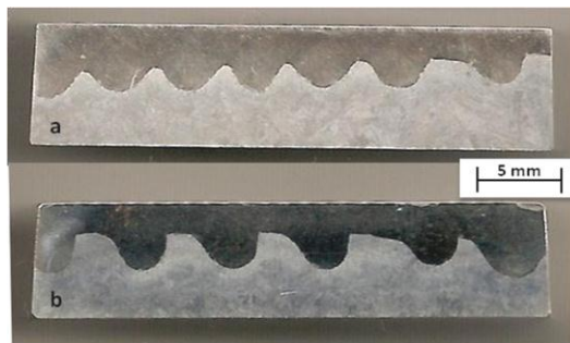
Figura 67 – Macrografias feitas em seção transversal das amostras cavitadas. a) AM120, b) AM170. Ataque químico: Vilella.
