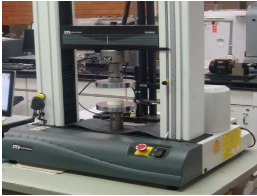
Figura 11 - Máquina universal testes Instron 3369 (LOPES, 2010).
