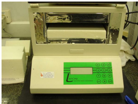
Figura 13 – Equipamento empregado para medir a condutividade térmica ou fator K (LOPES, 2010).
