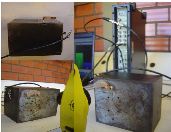
Figura 67-Medição da vibração das carcaças.
