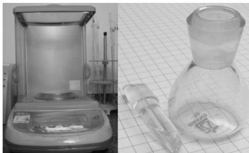
Figura 18-Balança digital e picnômetro.
