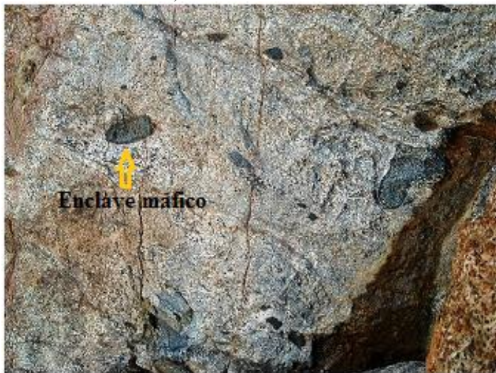
Foto 01 - Afloramento de gnaiss granulítico após escorregamento ocorrido em novembro de 2008. Observar os xenólitos máficos representados pelas manchas escuras na matriz mais clara. Fonte: Bausys, 2010.
