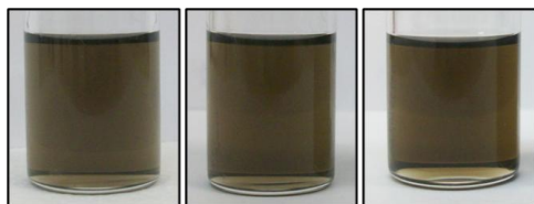
Figura 37. Nanopartículas de paládio suportadas em micelas reversas de ImS3-14, sintetizadas em w_0 7,0; da esquerda para a direita, 30 min, 6 e 9 dias após a mistura da sal de paládio e o agente redutor.
