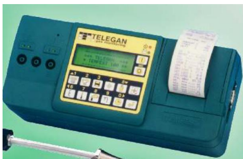
Figura 14. Analisador de gases inorgânicos modelo Tempest 100.
