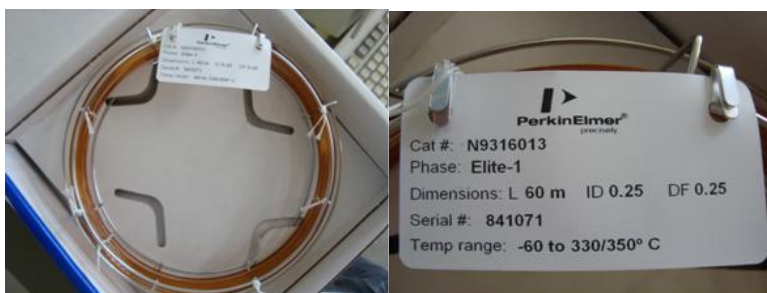
Figura 13. Fotos da coluna Elite-1 utilizada na análise do diesel.
