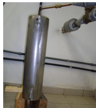
Figura 7. Trocador de Calor.
