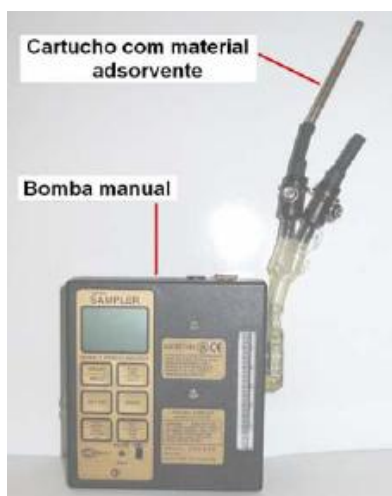
Figura 10: Amostragem com bombeamento de ar.
