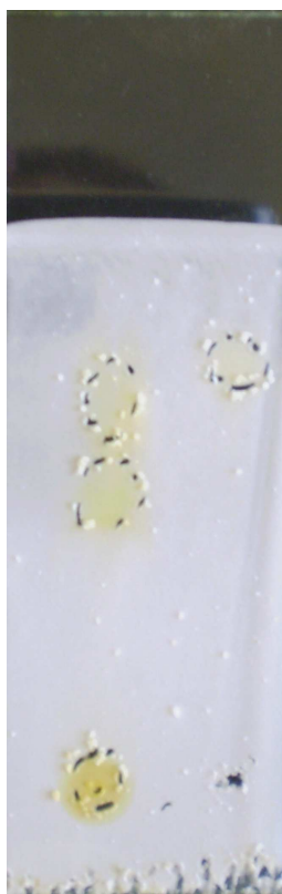
Figura 14 – Placa cromatográfica mostrando mistura de álcool e éster (esquerda) e do éster puro (direita).
