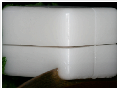
Figura 3. Blocos de cerâmica com espessura de 2 mm e área de aproximadamente 7 mm 2 , sendo cortados
