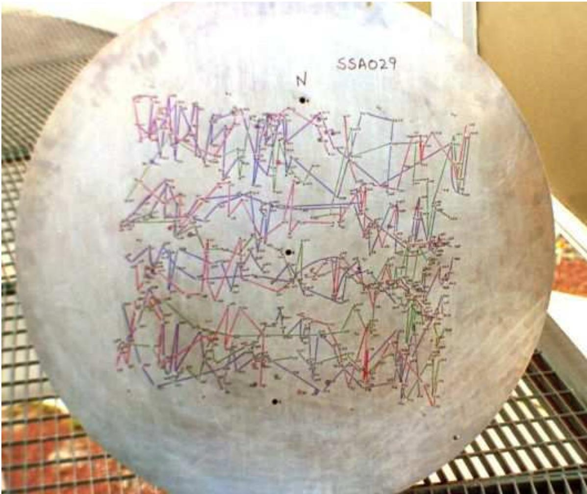
**Figura 2.2:** Exemplo de um prato de fibras do SDSS. Após fotografar o campo com um CCD, os pratos são marcados por um software e furados a fim de localizar as 640 fibras do espectrógrafo nos lugares correspondentes aos objetos que deseja-se analisar. Figura extraída de <http://www.sdss.org/>
