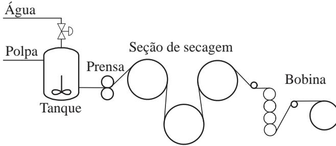
Figura 17: Esquema geral de uma máquina de produção de papel
