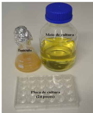
Figura 1 – Inóculo produzido em frascos cônicos de 125 mL; meio de cultura bacteriana composto de manitol, extrato de levedura e peptona, após autoclavagem; e placa de cultura de 24 poços onde foram preparadas as membranas de celulose bacteriana.
