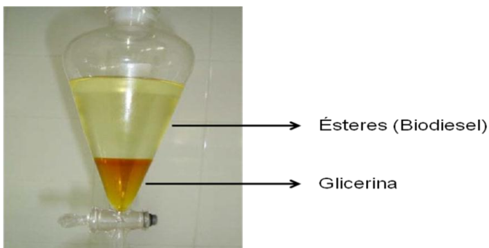
Figura 3.10. Separação da glicerina e do biodiesel. Fonte: Albuquerque, 2006.
