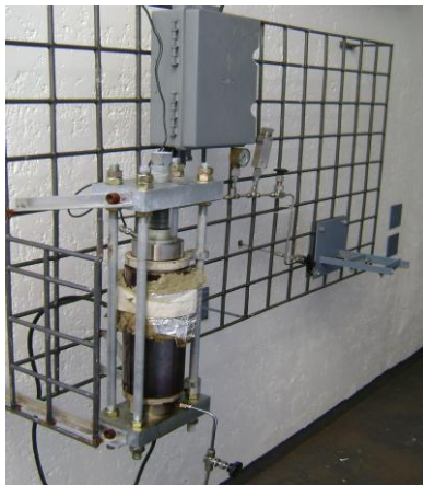
Figura 4.3. Unidade experimental empregada para produção de biodiesel utilizando sementes de pinhão-manso e etanol em estado supercrítico (LCP/UFSC, 2011).
