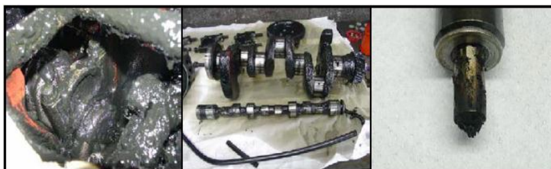
Figura 3.7. Acúmulo de carbono no motor entupimento do bico injetor provocado pelo uso de óleos vegetais não reagidos em motores de combustão interna. Fonte: Innocentini (2007) citado por Santos (2009).
