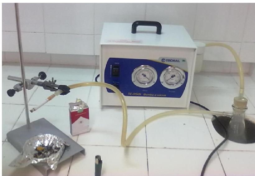
**Figura 11.** Sistema usado para queima dos cigarros e obtenção dos filtros empregados na determinação de CC e HQ.
