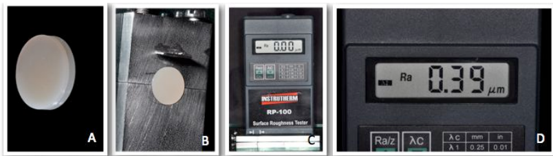
Figura 6 A-C- (A) Disco de resina composta (B) Matriz usada como suporte para o disco e rugosímetro (C) (D) rugosímetro portátil utilizado no estudo.
