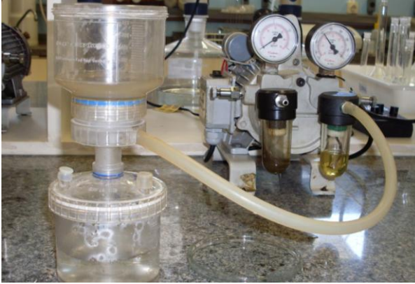
Figura 28 – Ensaio de sedimentos em suspensão
