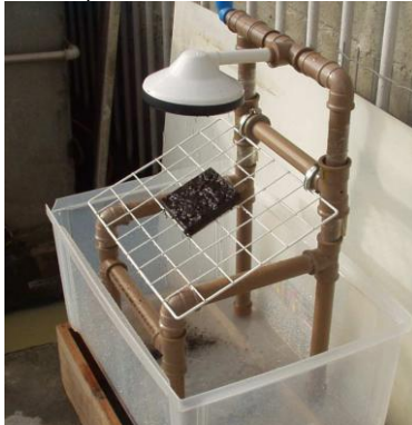
Figura 32 – Ensaio de Inderbitzen modificado com chuveiramento
