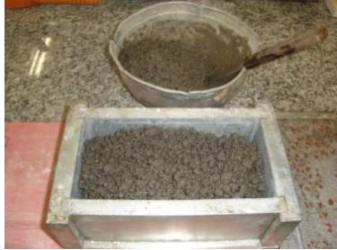
Figura 4.16 – Compactação da Camada de Base.
