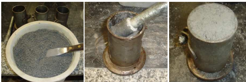
Figura 4.14 – Moldagem dos Corpos de Prova de Argamassa Fotocatalítica.
