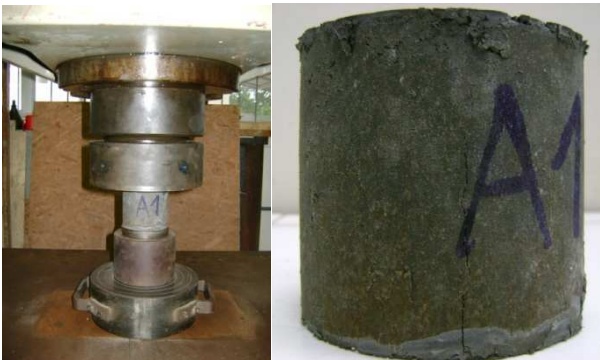
Figura 4.12 – Ensaio de Resistência à Compressão em Copos de Prova 9x8 cm (Diâmetro x Altura).
