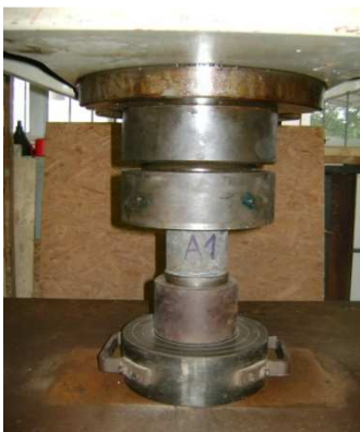
Figura 2.25 – Ensaio de Resistência à Compressão.
