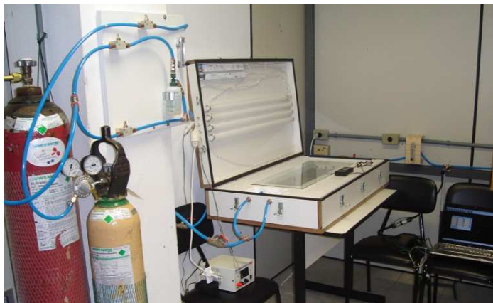
Figura 4.1 – Aparato Para Avaliação da Degradação de NO x Desenvolvido Nesta Pesquisa.
