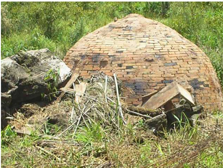
Figura 4 - Forno de Carvão no PA Zumbi dos Palmares (fonte: Cooptrasc, 2009)
