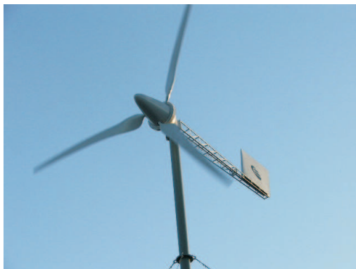
Figura 2.7: Turbina eólica para carregamento de baterias (ENERSUD; 6 kW). Fonte: www.enersud.com.br . Acesso em 01/03/2010.
