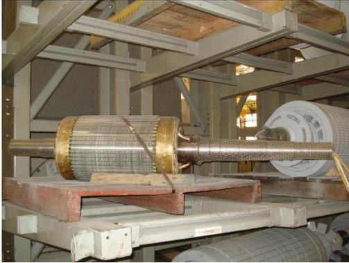
Figura 4.1.1.3 – Rotor da máquina assíncrona trifásica
