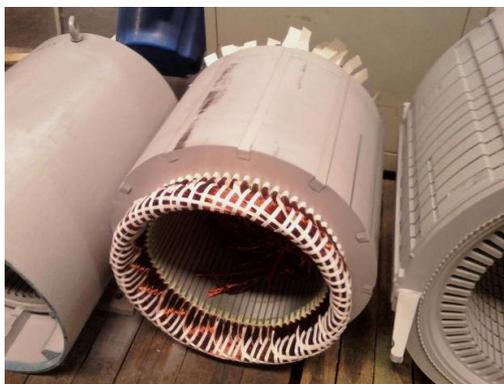
Figura 4.1.2 – Estator da máquina assíncrona trifásica
