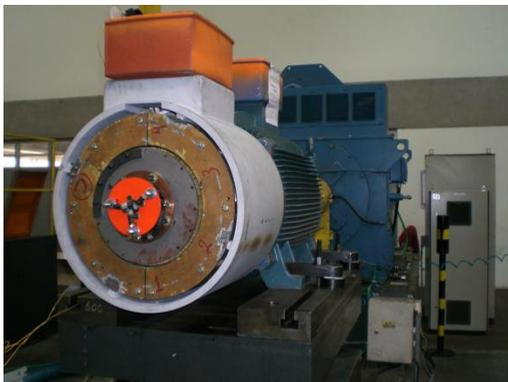
Figura 4.3.5 – Máquina assíncrona trifásica com transformador rotativo
