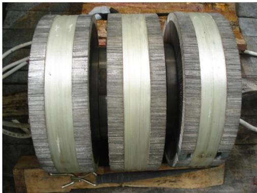
Figura 4.2.7.4 – Rotores com enrolamentos recobertos por bandagem
