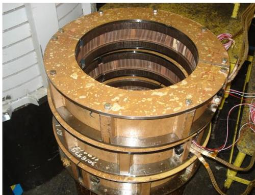
Figura 4.2.7.7 – Estatores do transformador rotativo
