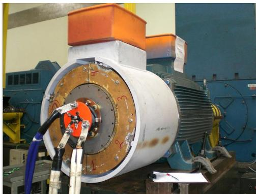
Figura 4.4.2 – Alimentação do transformador em ensaio de circuito aberto
