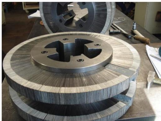
Figura 4.2.7.2 – Rotor do transformador rotativo
