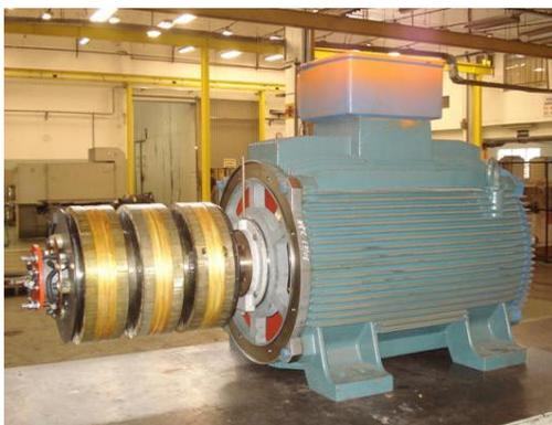
Figura 4.3.4 – Máquina assíncrona trifásica e rotor do transformador
