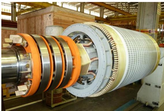
Figura 2.2.4 – Rotor bobinado com anéis de deslizamento
