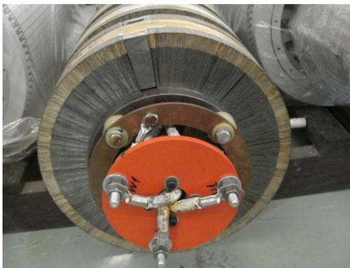
Figura 4.3.3 – Conexão elétrica entre os terminais dos rotores da máquina assíncrona trifásica e do transformador rotativo
