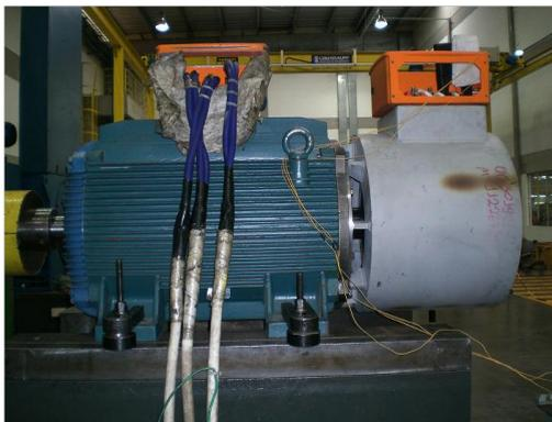
Figura 4.4.1 – Alimentação do estator em ensaio de curto-circuito da máquina assíncrona trifásica
