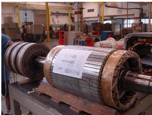
Figura 4.3.2 – Rotores da máquina assíncrona trifásica e do transformador rotativo montados sobre um eixo comum
