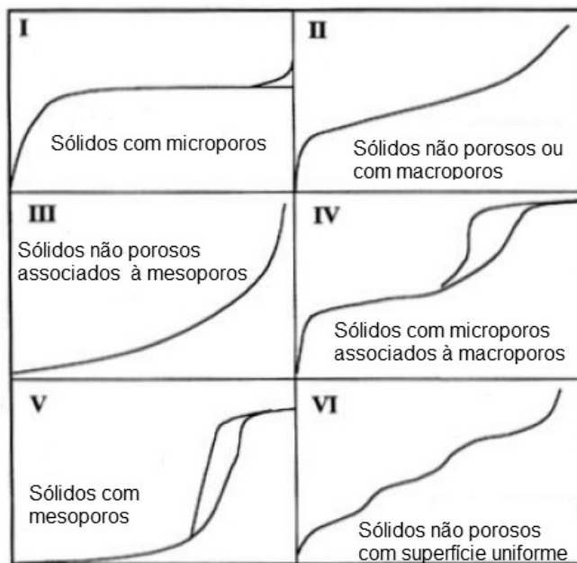
Figura 15. Isotermas (Volume do gás adsorvido (cm 3 .g -1 ) versus Pressão Relativa (P/P 0 )) do tipo I ao tipo VI. Classificação segundo a IUPAC.
