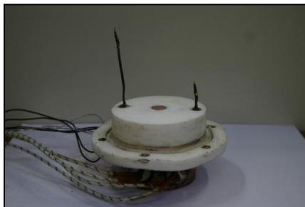
Figura 3.33 - Seção de teste inserida no bloco de teflon.
