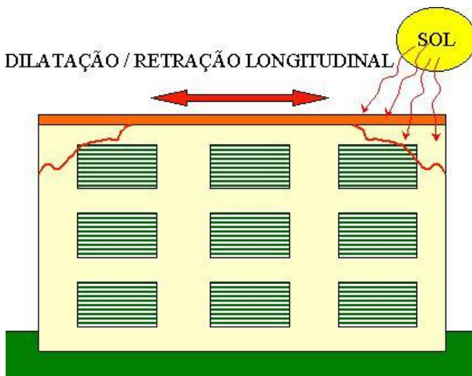
Figura 29: Fissura inclinada causada por movimentação térmica da laje de cobertura
