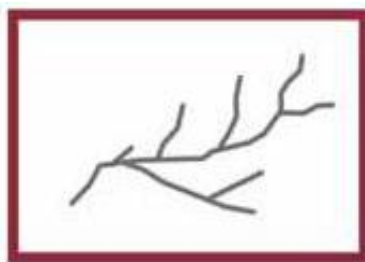
Figura 36: Fissura ramificada revestimento argamassado
