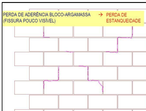
Figura 40: Fissura tipo "escada"
