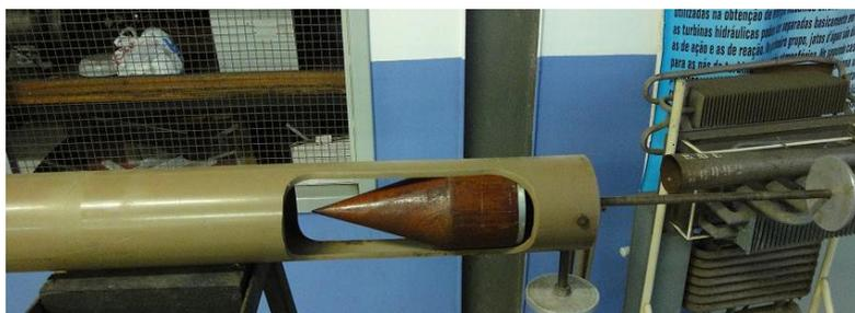
Figura 3.5 - Regulador de vazão.
