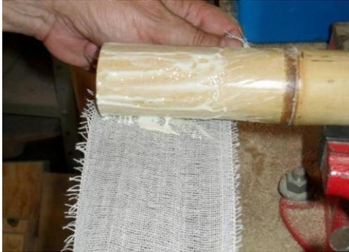
**Figura 77** - Atadura de crepom sendo enrolada no corpo de prova.
