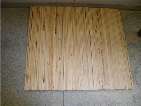
**Figura 45** - Estrutura em madeira do painel antes de ser colada e prensada.
