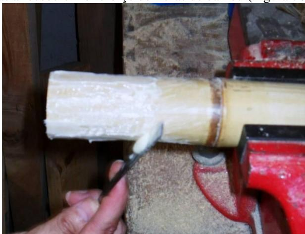
**Figura 76** - Cola Araldite sendo passada no corpo de prova.
