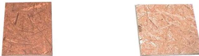
**Figura 33** - Painel de bambu com partículas orientadas – OSB.
