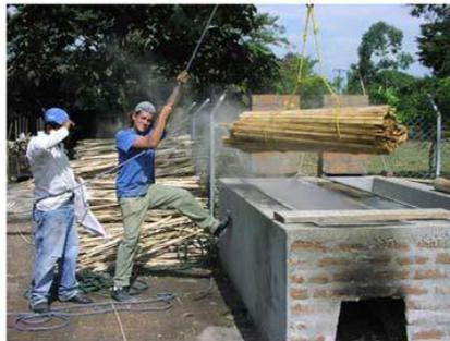
**Figura 18** - Processo de descolorir (*Bleaching*) tiras de bambu.
