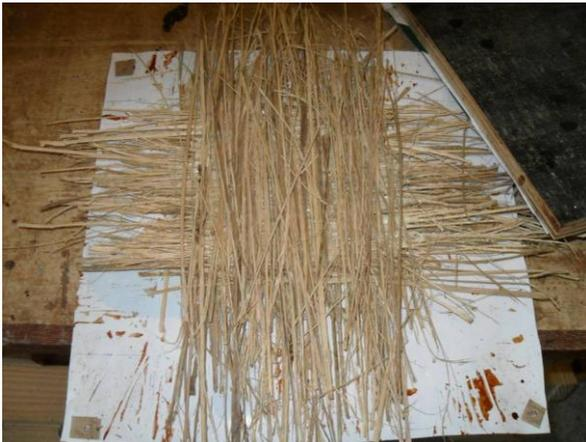
**Figura 85** - Fibras de bambu prontas para serem prensadas.
