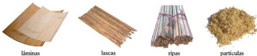
**Figura 15** - Lâminas, lascas, ripas ou partículas: amostras de material empregado nos painéis.
