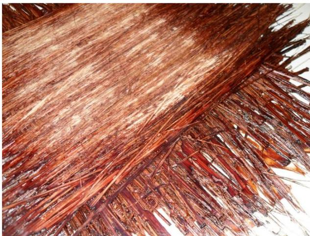
**Figura 87** - Painel de fibras de bambu com adesivo Resorcina-Fenol-Formaldeído finalizado.
