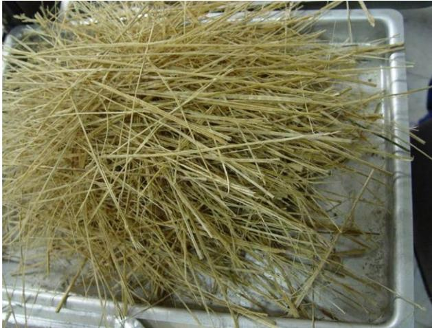
**Figura 73** - Feixes de fibras de bambu.
