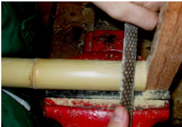
**Figura 75** - Corpo de prova tendo a camada lisa externa sendo raspada.
