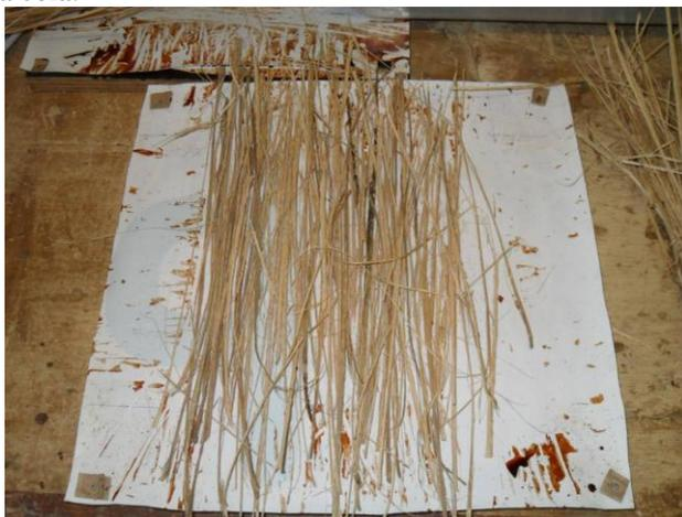
**Figura 83** - Primeira camada de fibra de bambu.
