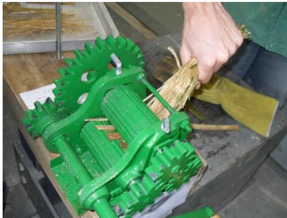
**Figura 70** - Ripas de bambu sendo passadas no moedor.
