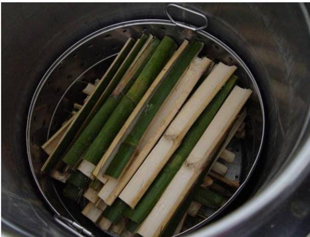
**Figura 69** - Ripas de bambu na autoclave vertical.
