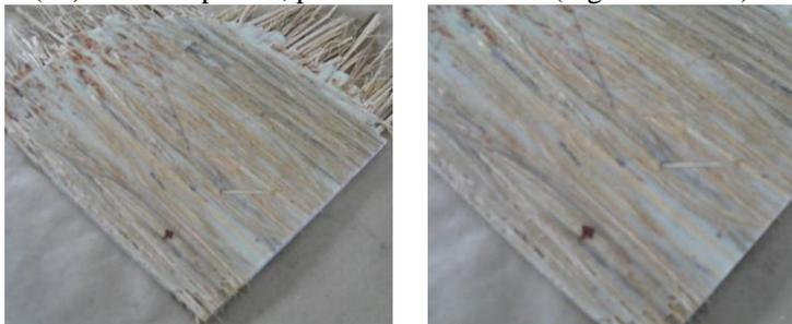
**Figura 86** - Painel de fibras de bambu com adesivo epóxi Araldite finalizado.
