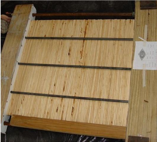
**Figura 48** - Após todas as ripas estarem com cola e posicionadas na prensa elas foram prensadas.
