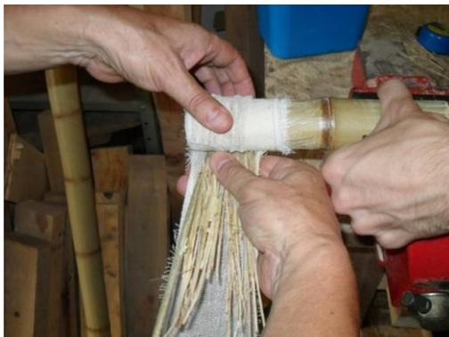
**Figura 78** - Atadura de crepom com feixes de fibras de bambu sendo enrolada no corpo de prova.
