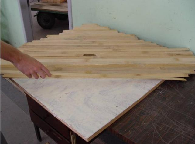
**Figura 51** - Colagem das lâminas de bambu no OSB de 800x800 mm.
