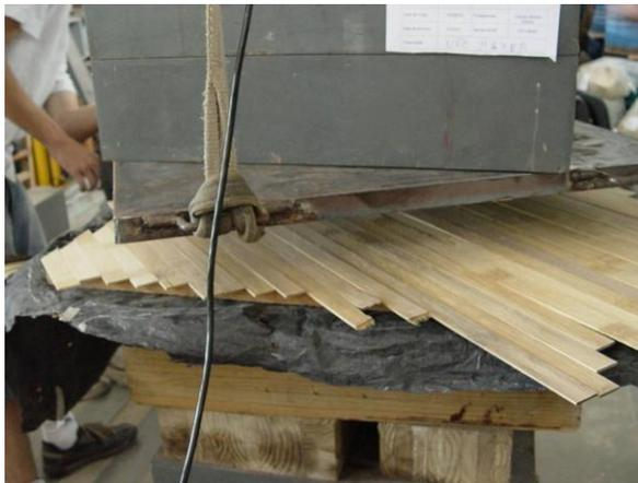
**Figura 52** - Ajuste do painel no dispositivo de prensagem.
