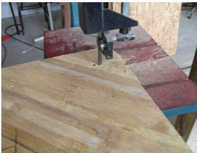
**Figura 57** - Painel sendo passado na serra fita para retirar as quinas.
