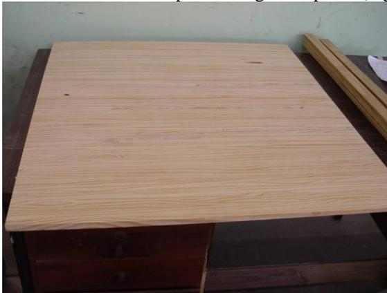
**Figura 49** - Parte da colagem das madeiras do painel finalizada.
