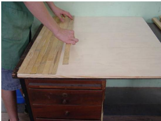
**Figura 50** - Colagem das lâminas de bambu *Dendrocalamus Giganteus*.
