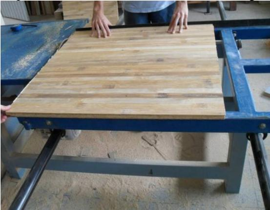
**Figura 55** - Painel sendo passado na *serra circular*.
