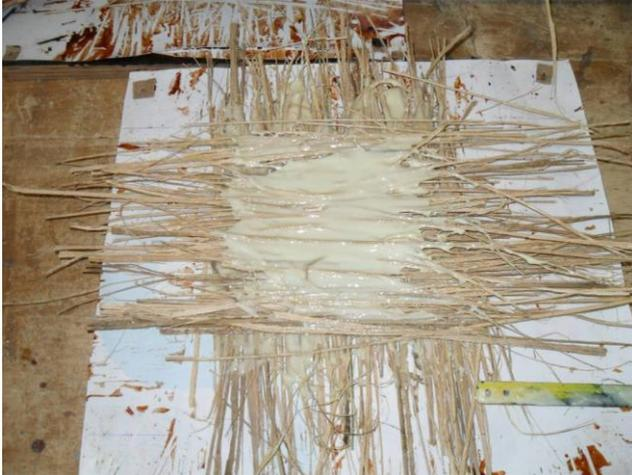
**Figura 84** - Segunda camada de fibra de bambu.
