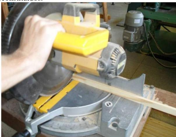
**Figura 44** - Ripas sendo serradas na serra destopadeira para ficarem com a dimensão de 10x800x20 mm.
