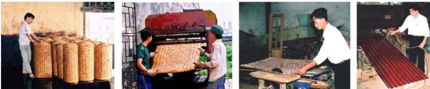
**Figura 30** - Processo de fabricação do painel ondulado.
