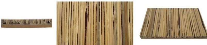
**Figura 35** - Painel de MDF revestido com ripas de bambu e pó de coco colado.
