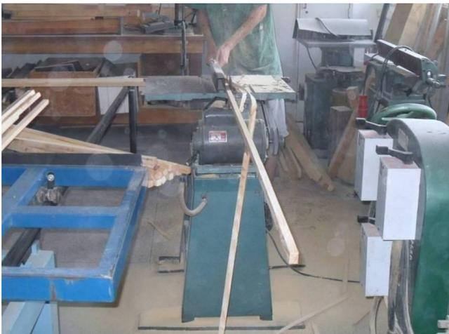
**Figura 42** - A madeira *pínus* sendo passada na serra circular.
