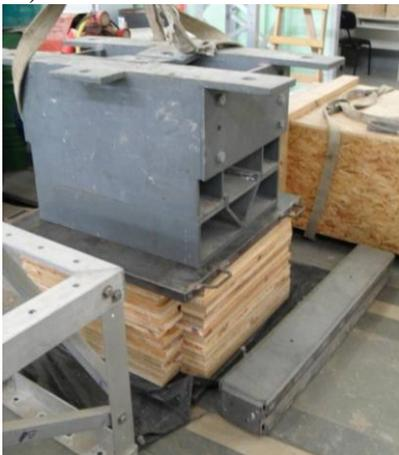
**Figura 60** - Prensagem do painel após enrijecimento das laterais.
