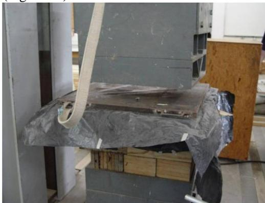
**Figura 53** - Lonas colocadas entre o painel e dispositivo.
