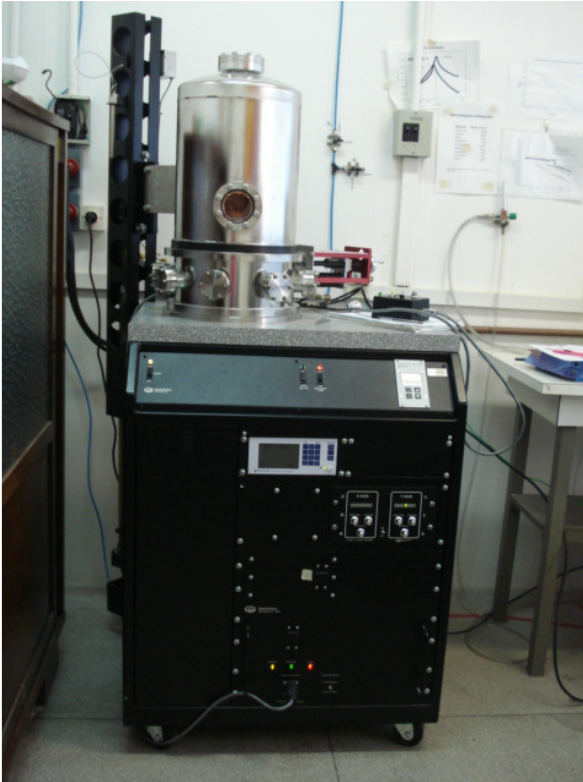
Figura 3.3: Evaporadora de canhão de elétrons usada na deposição de Au sobre Si.
