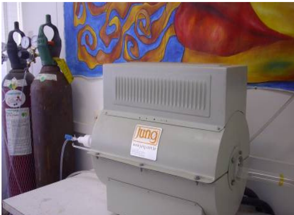
Figura 3.6: Fotos do forno de quartzo com gás argônio.
