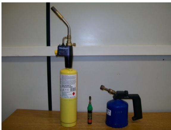
Figura 3.4: Maçaricos utilizados para o tratamento térmico com chama.
