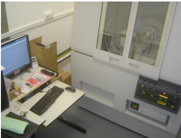
Figura 3.8: Difratômetro de raio X Expert-Pro (DEFIS/UFSC)
