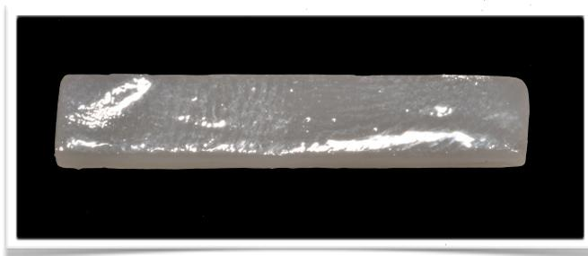
Figura 14 - Espécime de cerâmica após a queima da camada de glaze.
