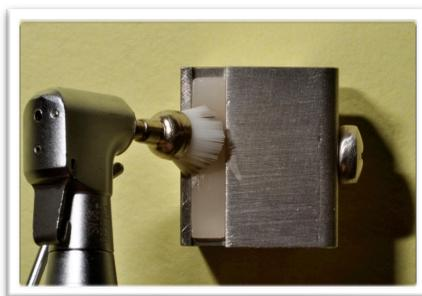
Figura 19 - Escova de nylon (Optrafine HP) utilizada em associação com a pasta diamantada.
