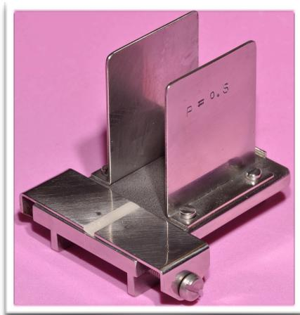
Figura 22 - Dispositivo metálico utilizado para possibilitar a leitura dos espécimes no Rugosímetro.
