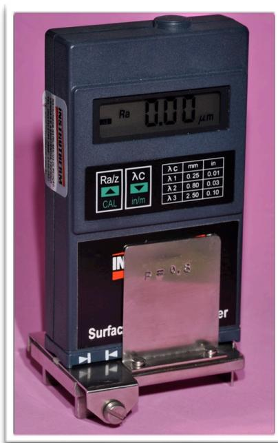
Figura 23 - Rugosímetro Digital Portátil com o dispositivo metálico e espécime em posição.
