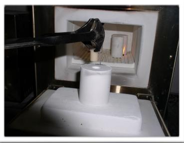
Figura 8 - Procedimento de prensagem à quente.
