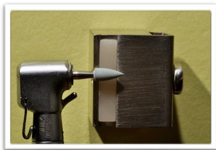
Figura 17 - Ponta de polimento de maior granulação (Optrafine F).
