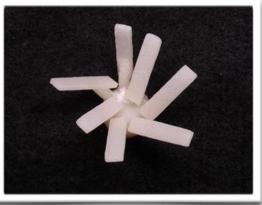
Figura 9 - Barras de cerâmica após remoção do revestimento.
