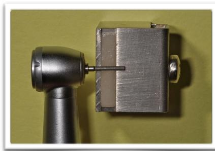
Figura 16 - Ponta diamantada 3098 FF posicionada paralelamente à superfície do espécime.
