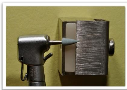
Figura 18 - Ponta de polimento de menor granulação (Optrafine P).
