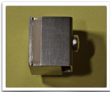
Figura 15 - Dispositivo metálico para apreensão dos espécimes.
