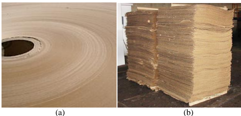
Figura 4 - Polpa Kraft de Pinus, em rolo (a) e folhas (b). (Fonte: Celulose Irani S.A.)
