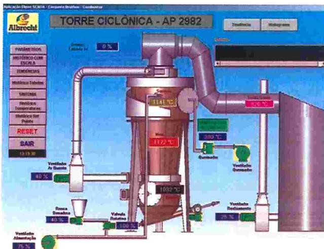
Figura 11: Painel de controle da configuração vertical V da planta piloto
