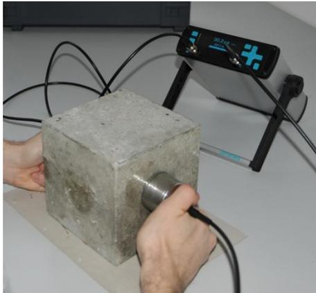
**Figura 2.13 – Exemplo de ensaio ultrassônico**
