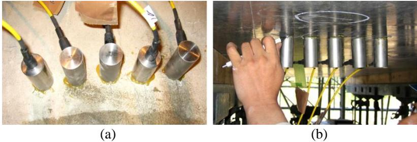
**Figura 2.40 – Execução do ensaio - (a) fixação dos transdutores - (b) fonte de impacto**
