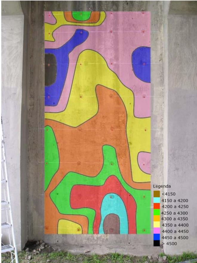
**Figura 2.19 – Exibição do pilar com as curvas de velocidade (m/s) obtidas nas leituras ultrassônicas**
