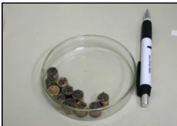
Foto 9: Vista detalhada dos sedimentos fixados aos stubs antes de levadas ao microscópio de varredura eletrônica (Foto de Caio Heidrich, outubro de 2010).
