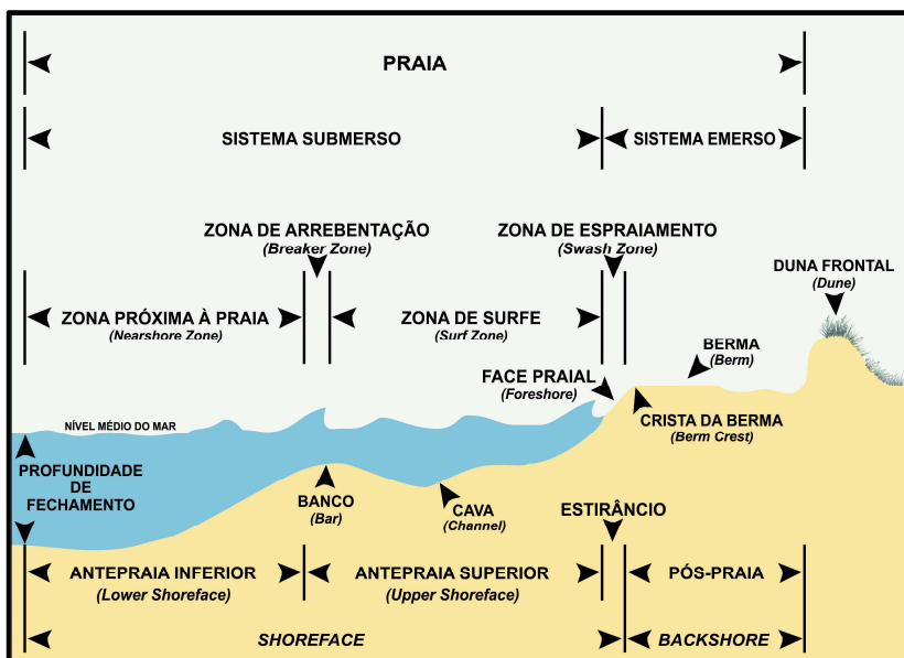
Figura 1: Esquemática de um perfil teórico de uma praia arenosa oceânica, adaptado de Short (1999) e Felix (2010).
