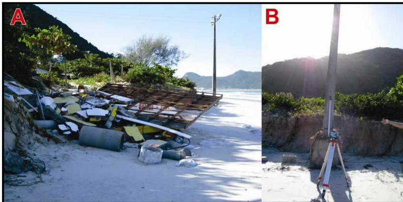
Foto 10: A) Vista em detalhe dos resultados da ressaca na praia da Solidão, com a demolição do posto de salva-vidas pela ação erosiva causada pela ondas (Foto de Caio Heidrich, abril de 2010). B) Vista em detalhe do poste utilizado como marco topográfico da medição do perfil praiar da praia da Solidão, onde a ação erosiva causada pela ressaca retirou as areias que cobriam a sua base (Foto de Caio Heidrich, abril de 2010).
