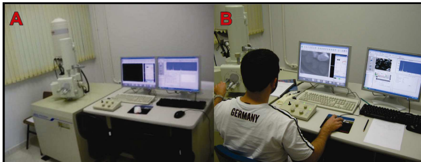
Foto 8: Microscópio eletrônico de varredura JEOL JSM-6390LV. Em (A) o equipamento aparece em sua totalidade, com os monitores para visualização interna das amostras (Fonte: http://lcme.ufsc.br ). Em (B), o equipamento está sendo operado pelo monitor responsável (Foto de Caio Heidrich, outubro de 2010).
