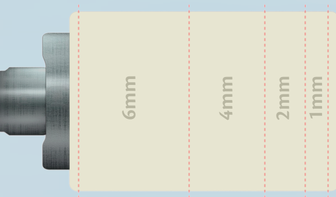
Figura 7: Representação esquemática do corte dos blocos. Em virtude das dimensões dos blocos IPS Empress CAD I12 (15mm de comprimento) e da perda de estrutura na região do corte, foram necessários dois blocos HT e dois blocos LT para a obtenção de todas as espessuras de cerâmica avaliadas: 1mm, 2mm, 4mm e 6mm.
