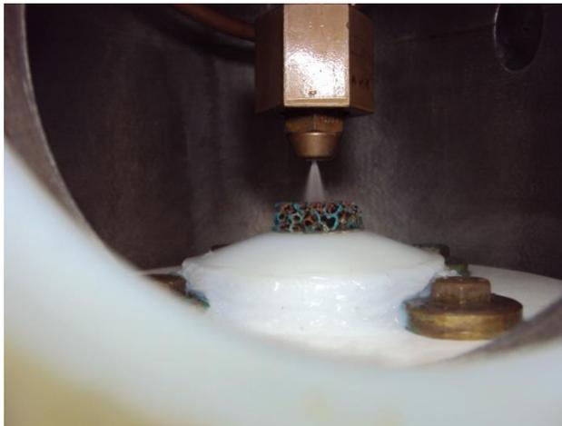
Figura 5.17 – *Spray Cooling* sobre a superfície com espuma metálica porosa
