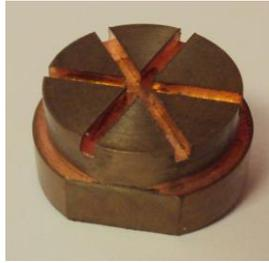
Figura 3.8 – Superfície aletada com canais radiais
