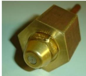
Figura 3.11 – Fotografia do bico injetor
