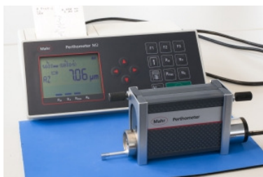
Figura 52: Rugosímetro utilizado nos ensaios.
