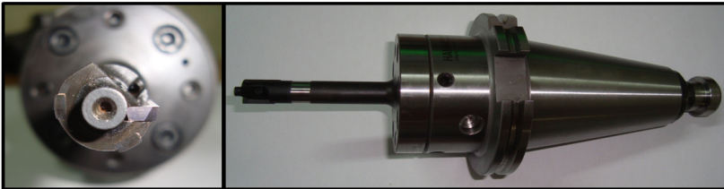
Figura 44: Alargador utilizado nos ensaios.
