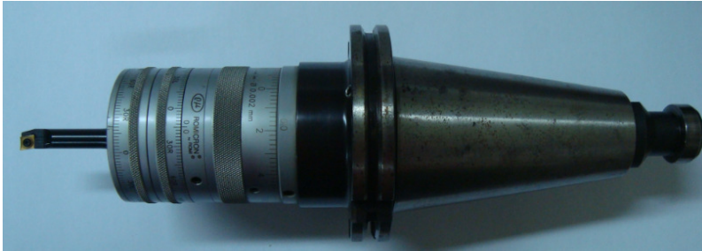
Figura 46: Ferramenta de mandrilar utilizada nos ensaios.
