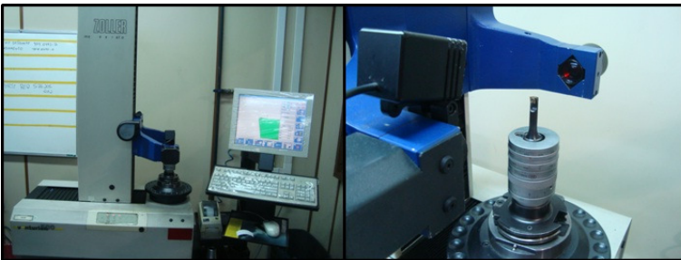
Figura 50: Preseter utilizado para regulagem do mandrilador.
