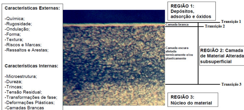
Figura 11: Seção esquemática de uma superfície de aço usinada [19].
