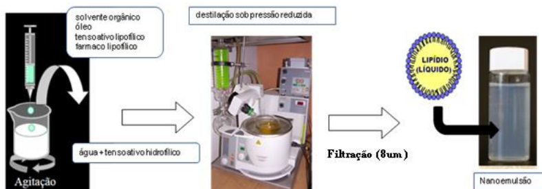
Figura 16: Esquema de preparação de nanoemulsões pela técnica de emulsificação espontânea.
