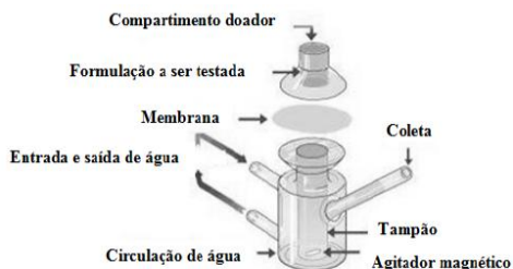
Figura 22: Célula de difusão de Franz (SILVA et al. , 2010).
