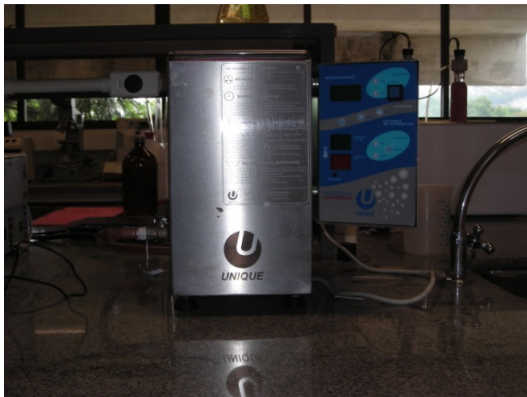
Figura 12: Ultrassom com aquecimento utilizado na regeneração do carvão.
