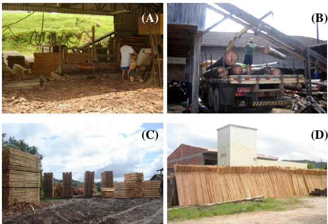
Figura 7. (A) Desdobro de tora de Pinus spp.; (B) Descarregamento de toras de Eucalyptus spp.; (C) Estoque de madeira de espécies exóticas em pátio de serraria; (D) Secagem ao ar livre de madeira serrada de Pinus spp. em pátio de serraria na Microrregião Geográfica de Florianópolis.
