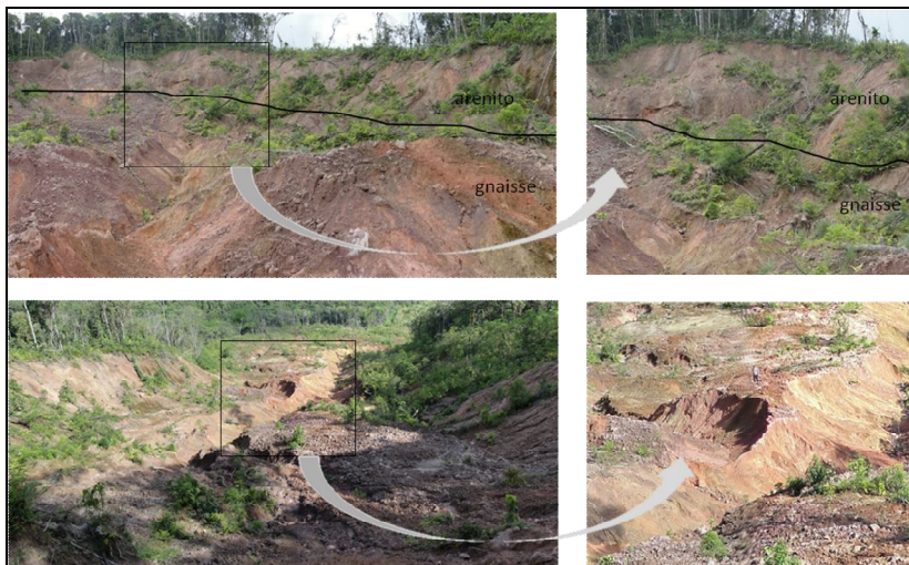
Figura 83: Detalhe do escorregamento da figura 82 (UTM 705627/7030824). As imagens superiores demonstram a crista do escorregamento e o contato litológico do arenito no topo do gnaisse. As imagens inferiores destacam a formação de novas cabeceiras de drenagem na massa deslizada provocada pela erosão superficial. Fotos: autor, dezembro de 2010.
