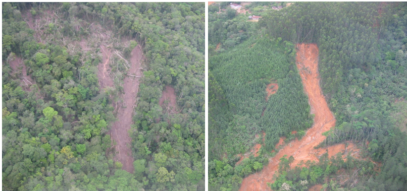
Figura 13: Escorregamentos translacionais na Bacia do Ribeirão do Baú, Ilhota, SC (área de estudo). Diversos escorregamentos translacionais nos eixos de drenagem na formação geológica do grupo Itajaí – arenitos (imagem da esquerda); Deslizamento de grande amplitude ocorrido sobre o Complexo Luiz Alves em área de reflorestamento (imagem da direita). Os deslizamentos foram seguidos de fluxo de detritos. Fotos: Joel Pellerin, 02/12/2008.
