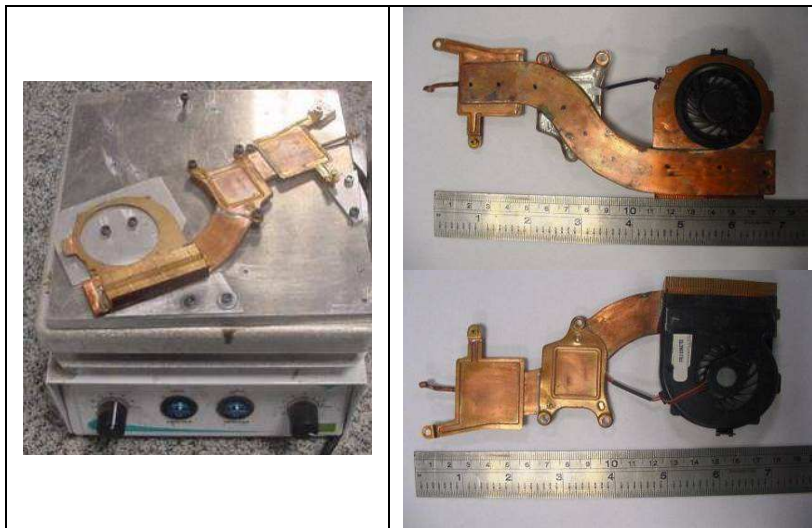
Figura 4.40: Gabarito para a montagem dos componentes de fixação sobre o minitubo e o minitubo híbrido após a soldagem.
