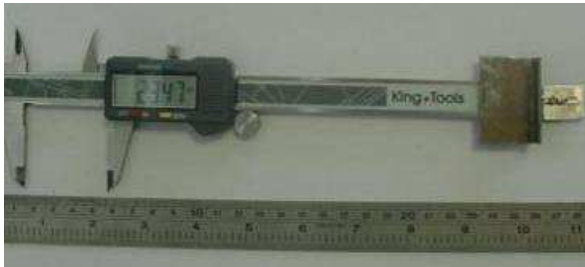
Figura 4.8: Dispositivo construído para espalhar o pó de cobre sobre as placas.
