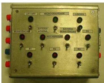
Figura 4.32: Controle para testes e recarregamento das baterias.
