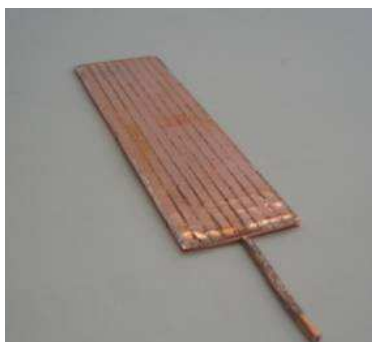
Figura 4.5: Minitubo de calor fios-placas após a última etapa do processo de fabricação.
