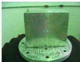
Figura 4.35: Ensaios em vibração senoidal no IAE – São José dos Campos/SP.
