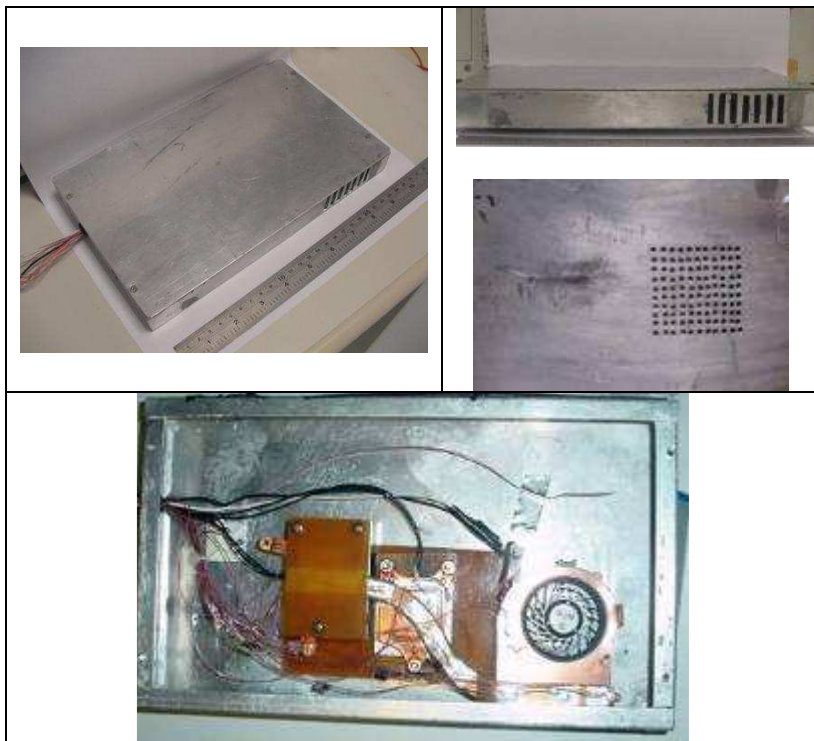
Figura 4.38: Caixa de alumínio para testes do minitubo de calor híbrido.
