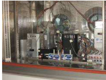
Figura 4.34: Ensaios de ciclo térmico no IAE – São José dos Campos/SP.
