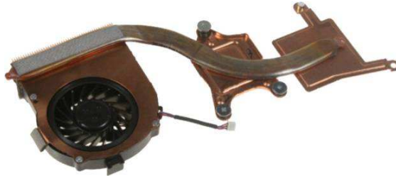
Figura 4.2: Dispositivo de dissipação de calor do computador portátil Thinkpad X200 da IBM®.
