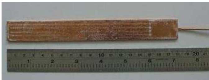
Figura 5.44: Minitubo de calor híbrido reto de 20 mm de largura por 180 mm de comprimento.
