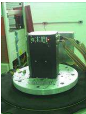
Figura 4.35: Ensaios em vibração senoidal no IAE – São José dos Campos/SP.
