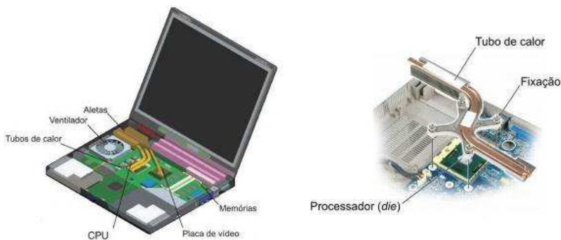
Figura 2.7: Esboço de um computador portátil (fonte: Viswanath, 2000) e o dispositivo para controle de temperatura.
