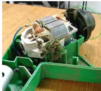
b) Imagem da sujeira no motor
