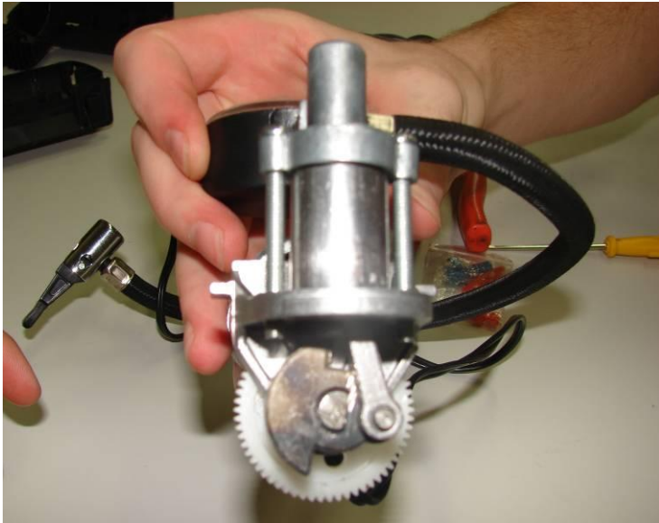
Figura 5.4. Desmontagem do compressor: grupo U3. Detalhe do subsistema de compressão.
