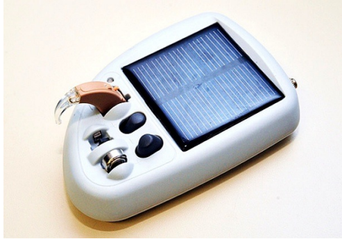
Figura 1.21: Aparelho auditivo recarregável a energia solar (SOLAR EAR, 2010).
