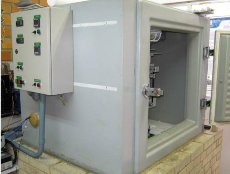
Figura 5.9: Câmara de temperatura controlada.
