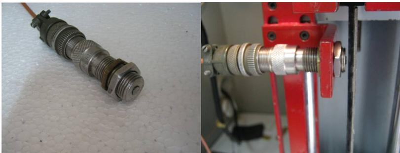
Figura 5.7: Transdutor MOTION SENSORS PC55-18E.
