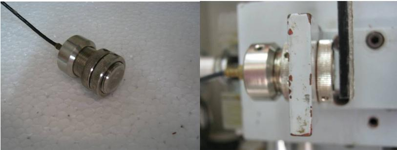
Figura 5.6: Transdutor magnético B&K MM0002.
