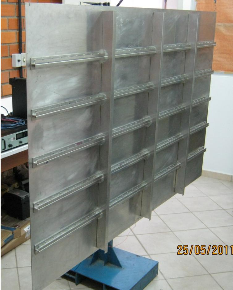
Figura 5.1: Painel de fuselagem sem material viscoelástico aplicado.
