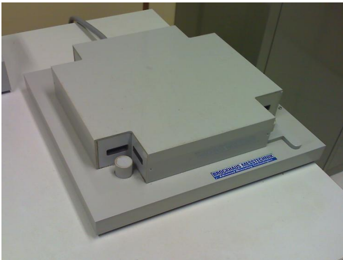
Figura 2.2 - Quadro de Epstein utilizado nos ensaios.
