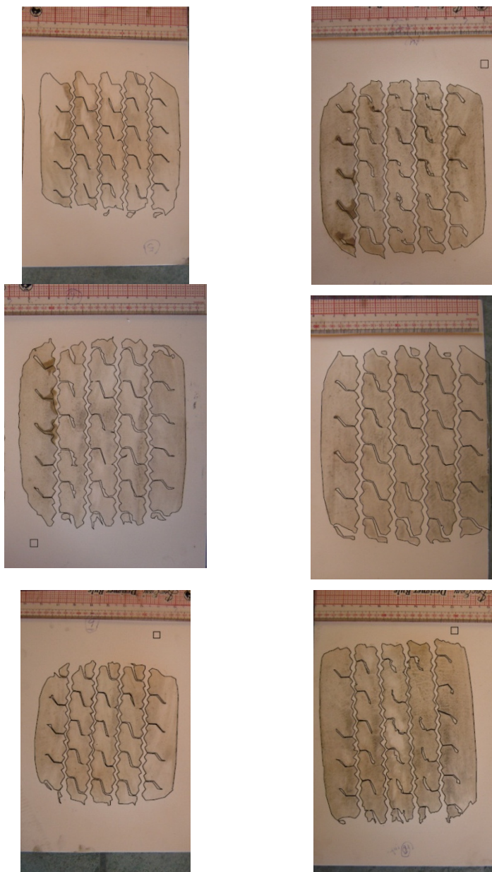
Figura A.84 Impressão de pneus do guincho com polilinhas delimitando as áreas
